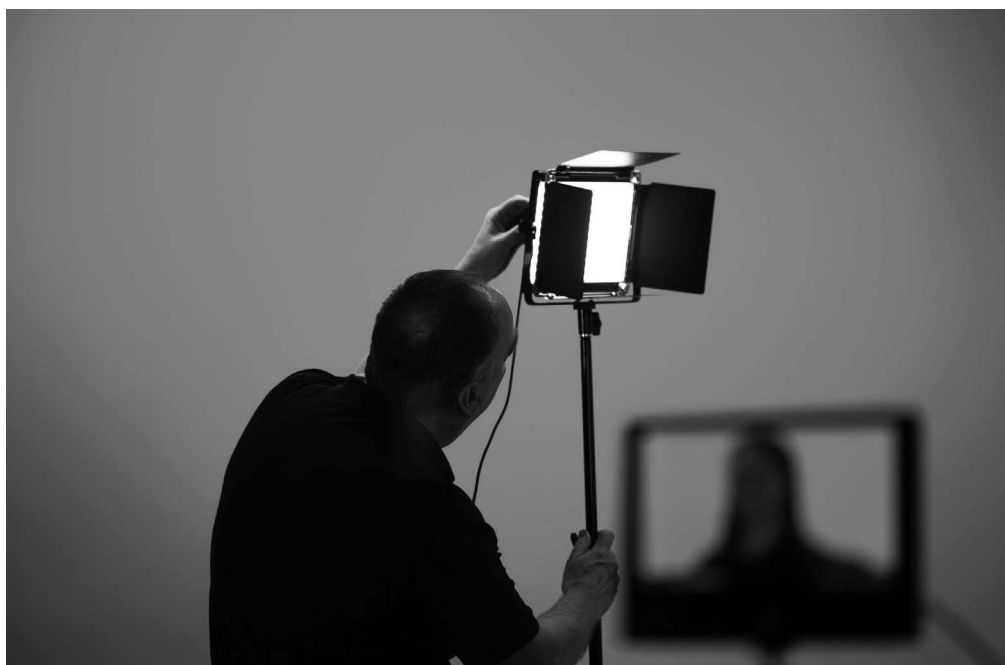
9.11 Ravnomerno osvetljenje hroma-ki pozadine kao preduslov za kvalitetan keying
