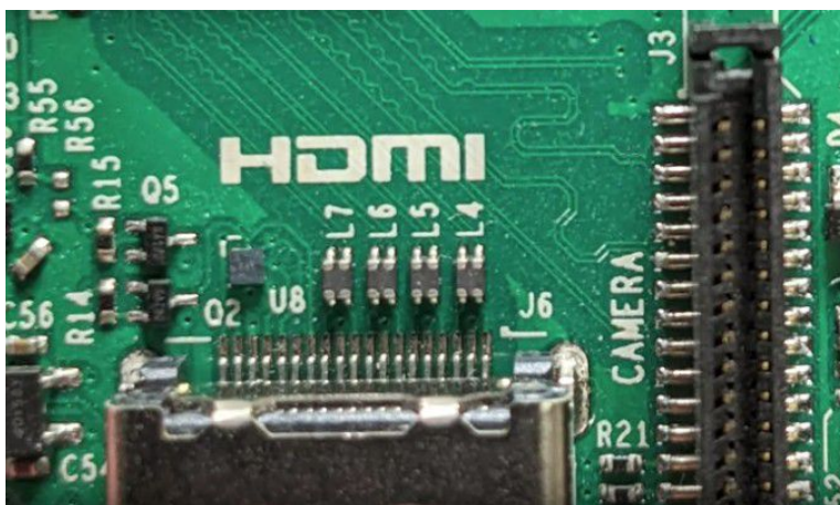
Slika 6.4: Primer vijuganja kod diferencijalnog signala (SoC – kamera).
