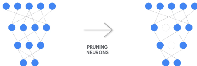
Slika 9.8: Ilustracija kompresije ML modela tehnikom orezivanja.
