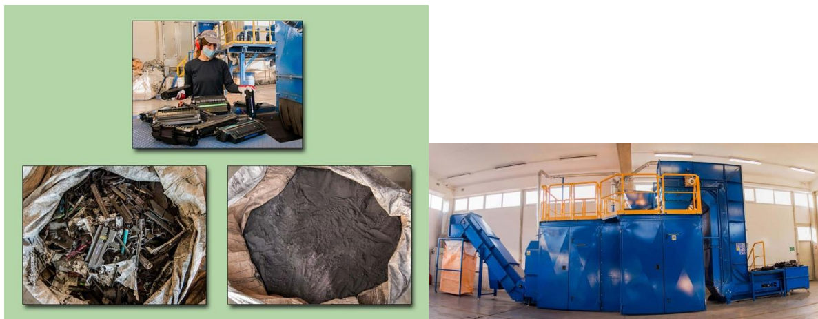
слика 1.6 Рециклирање тонера у фабрици одвајање црног праха и осталих делова и машина за рециклажу
