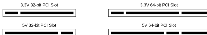
слика 1.13 Различите варијанте PCI слота на матичној плочи
