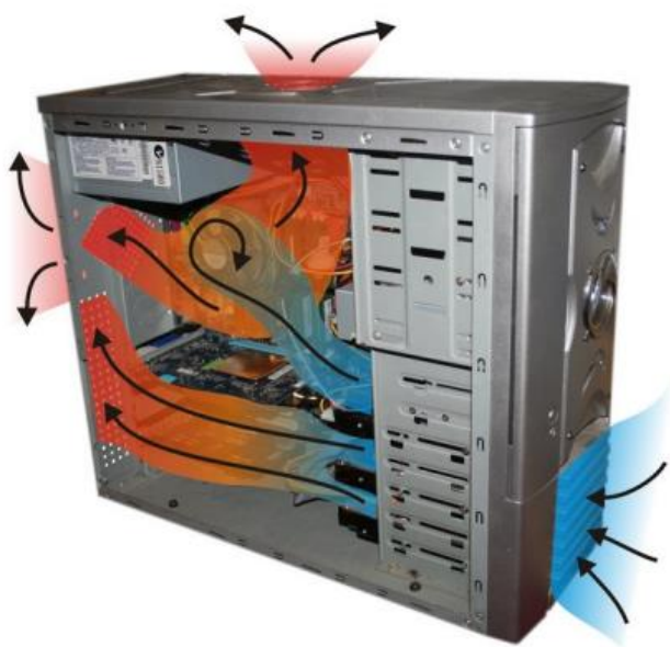
слика 1.4 Правилна циркулација ваздуха у кућишту подразумева барем један удувни и издувни вентилатор
