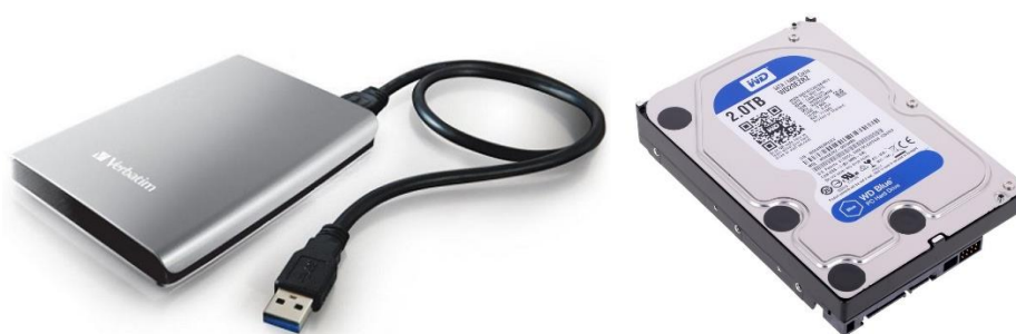
слика 1.4 Интерни и екстерни HDD уређаја
