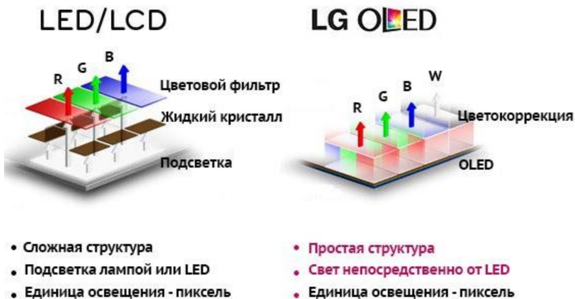
слика 1.9 Принцип рада LED и OLEDмонитора
