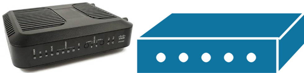
слика 1.3 Модем и симбол модема
