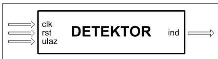
Slika 20.1 Blok šema detektora sekvence
