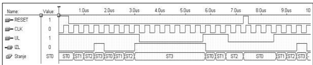
Slika 13.3 Simulacioni dijagram verifikacije rada sistema sekvencijalne mreže
