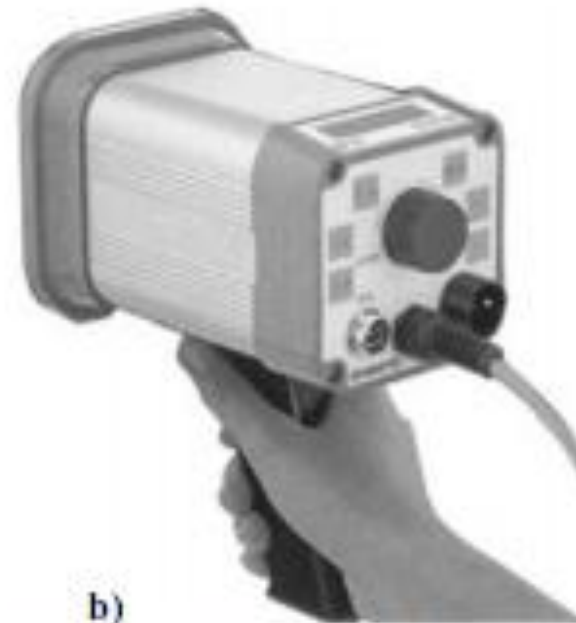
Slika 16.15. Stroboskop: a) merenje sa stroboskopom, b) izgled stroboskopa
