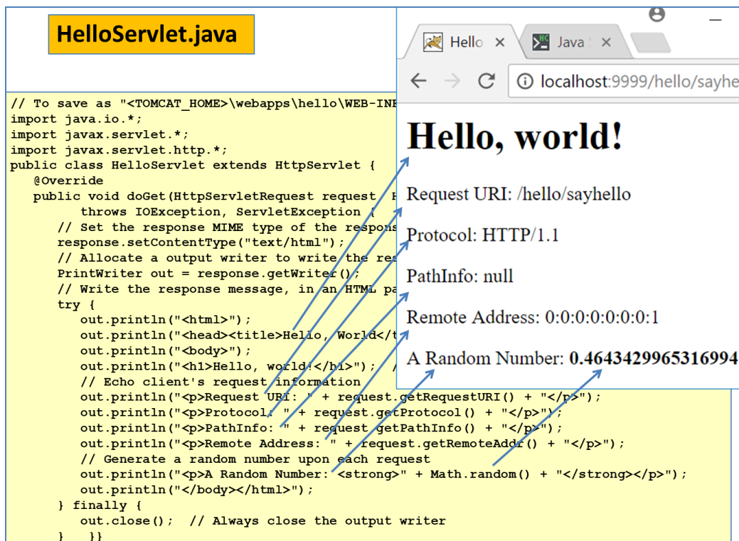
Слика 4.1.17 Јава класа HelloServlet.java и приказ у прегледачу
