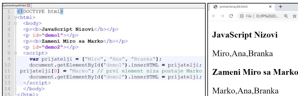
Слика 3.2.1 Промена вредности првог елемента низа и приказ свих чланова низа.
