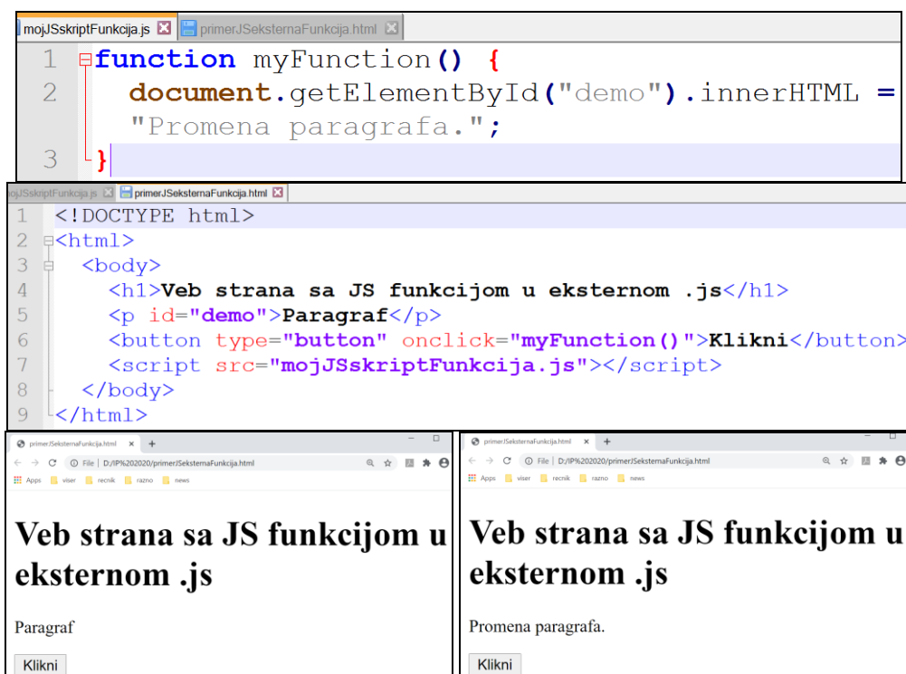
Слика 3.1.16 Промена параграфа са функцијом у екстерном .js фајлу.
