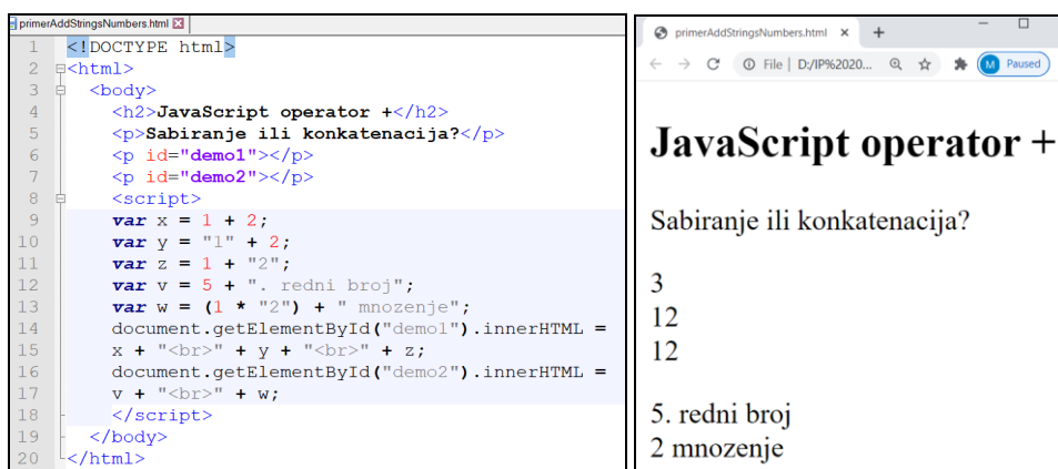
Слика 3.1.28 Оператор + за аритметичко сабирање и конкатенацију стрингова.
