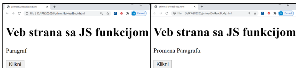
Слика 3.1.14 Промена параграфа са функцијом у <head> -у и дугметом у телу.
