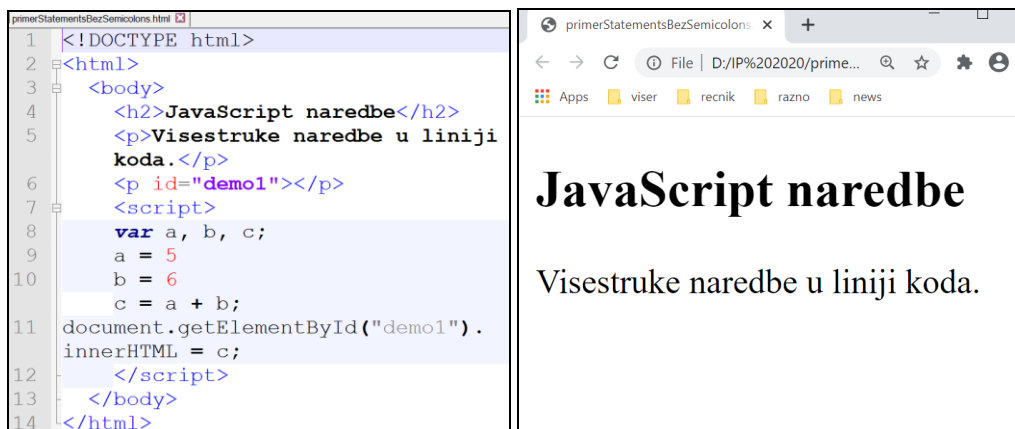
Слика 3.1.24 Више наредбе без ознаке ; у једној линији кода не даје исправан резултат у прегледачу.
