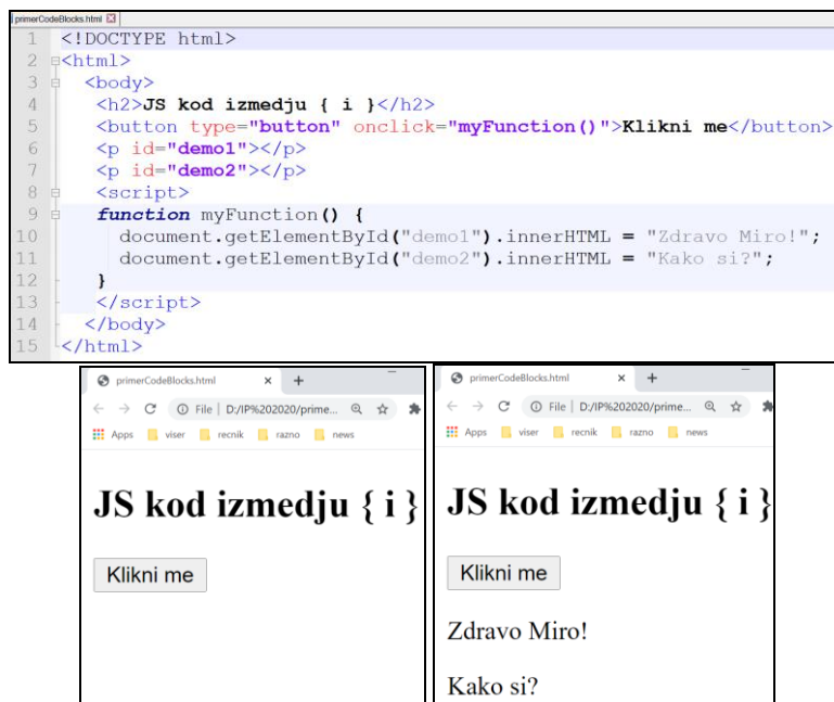
Слика 3.1.27 Блок кода између витичастих заграда { и }.
