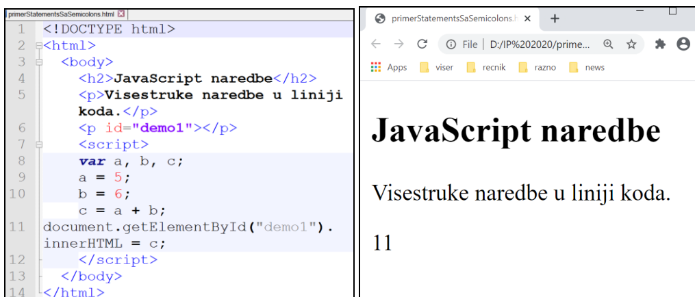
Слика 3.1.25 Више наредби са ознакама ; у једној линији кода дају исправан резултат у прегледачу.
