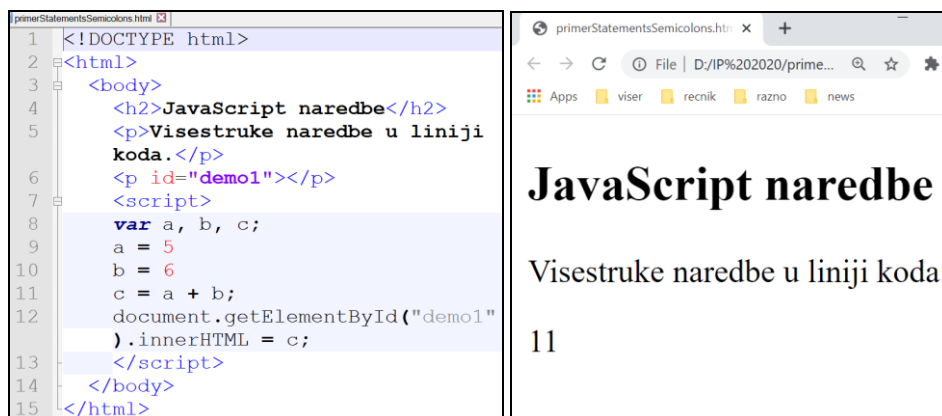
Слика 3.1.23 Наредбе са и без ознаке ; за исправан рад у прегледачу.
