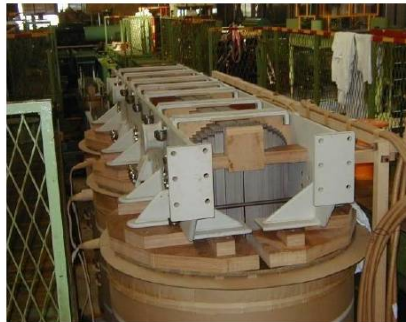
Načini slaganja limova u feromagnetnom jezgru. "Koso" slaganje
