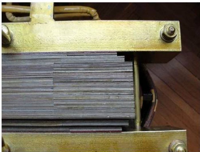
Načini slaganja limova u feromagnetnom jezgru. "Pravo" slaganje
