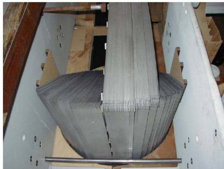
Načini slaganja limova u feromagnetnom jezgru. "Koso" slaganje
