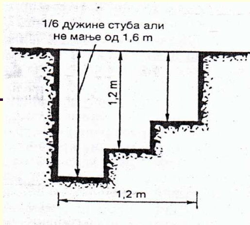
Slika 2.2. Oblik ručno kopane jame za stub
