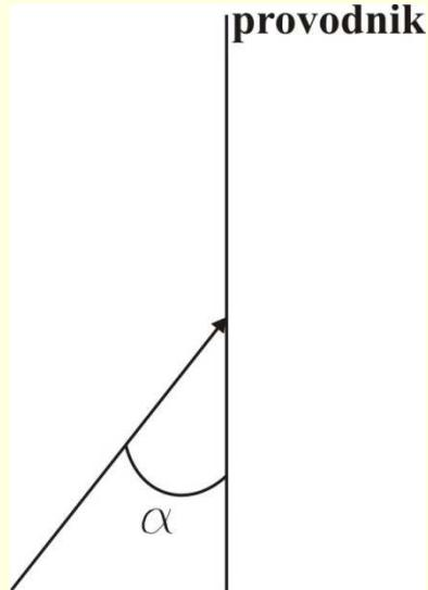
$\alpha$  = napadni ugao vетра ( $\alpha = 90^\circ \Rightarrow \sin \alpha = 1$ )
