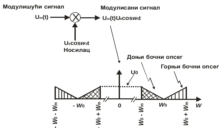
Слика 3. Амплитудна модулација с два бочна опсега
