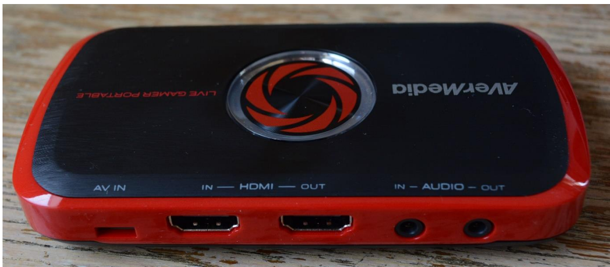
Слика 8. AVerMedia LiveGamerPortable C875 екстерна capture картица
