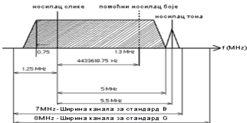
Слика 5. Структура РФ канала код земаљске ТВ дифузије
