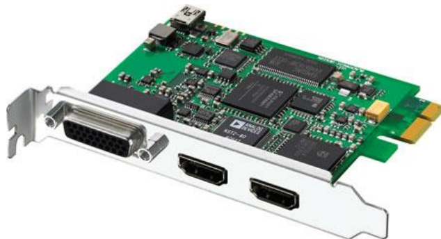
Слика 1. Blackmagic Intensity Pro HDMI Capture картица
