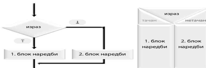
Слика 8. Селекција једног од два блока наредби
