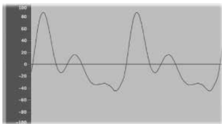
Slika 7.7: Testerasti signal propušten kroz filter sa izraženim efektom zvonjave granične frekvencije od 660 Hz
