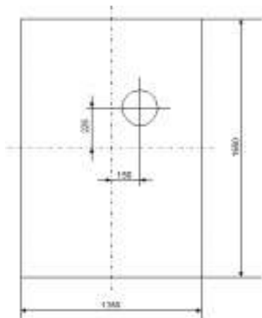
Slika 7.22 – Standardizovana ploča za merenje karakteristika zvučnika sa nesimetričnim mestom za ugradnju mernog uzorka
