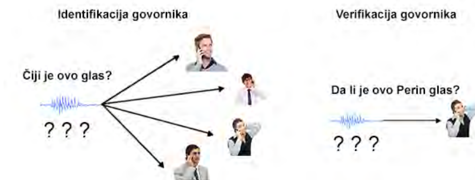
Slika 12.13 – Princip identifikacije (levo) i verifikacije (desno) govornika
