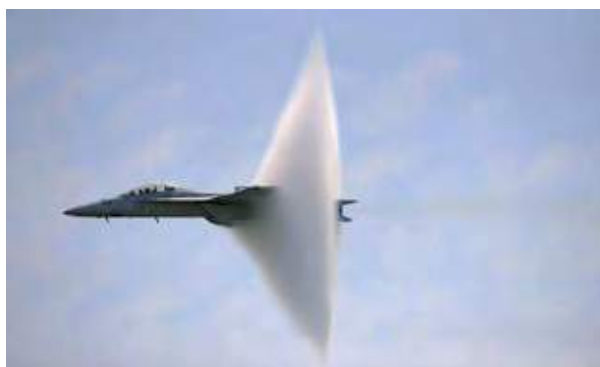
Slika 1.43 – Oblak kondenzovane vodene pare iz vazduha koji se može videti oko aviona koji leti nadzvučnom brzinom
