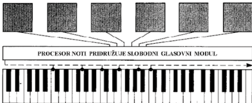
Slika 5.4: Princip rada šest polifonog sintisajzera
