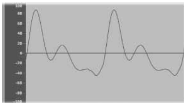
Slika 2.7: Testerasti signal propušten kroz filter sa izraženim efektom zvonjave granične frekvencije od 660 Hz
