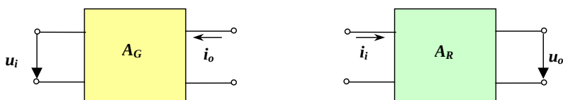
Слика 2.35. Транскондуктансни и трансрезистансни појачавач
