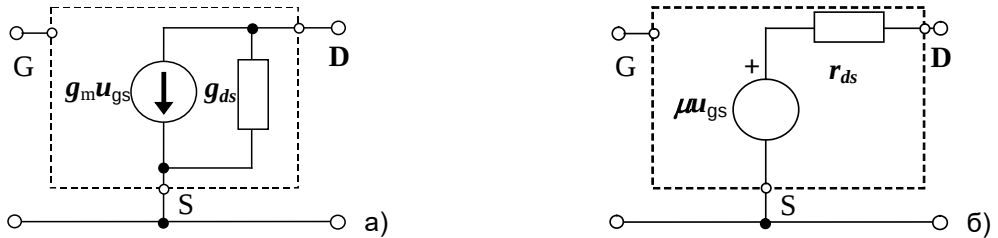
Слика 5.20. Еквивалентна кола транзистора са ефектом поља
