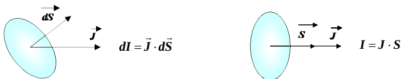
Слика 1.1. Дефиниција густине електричне струје
