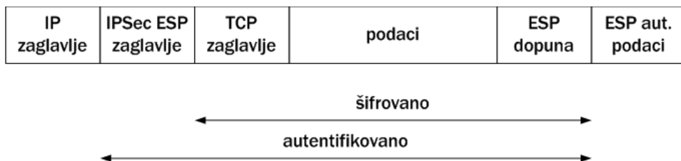
Slika 4.9. ESP u transportnom režimu rada
