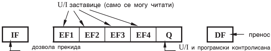
Слика 5.3. Реч стања процесора за микропроцесор CDP 1802
