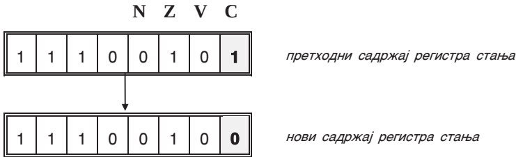
Слика 5.6. Утицај инструкције clear carry на регистар стања
