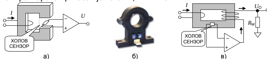
Слика 12.21. Мерење струје помоћу Холовог сензора
