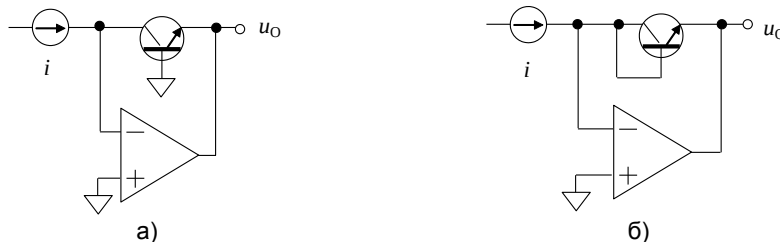
Слика 3.8. Логаритамски појачавач са транзистором
