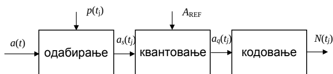
Слика 10.2. Општи функционални блок-дијаграм А/Д претварача
