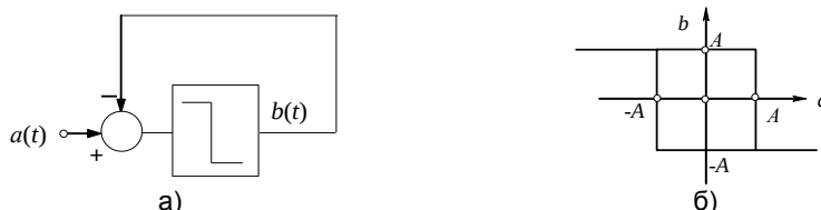
Слика 11.22. Остваривање хистерезиса код инвертујућег компаратора
