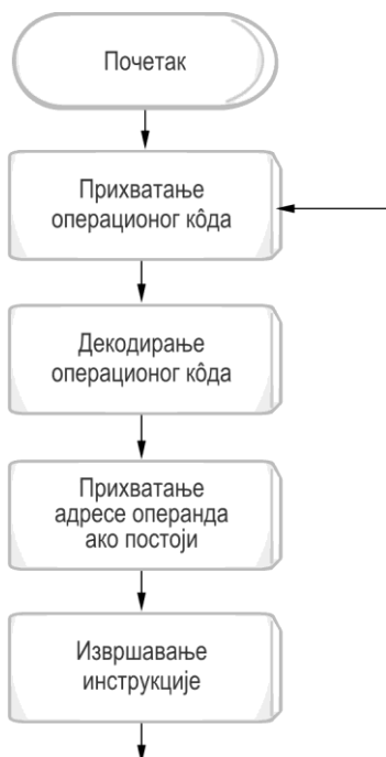
Слика 3.5 Серија корака у извршавању програма процесора MC68HC11
