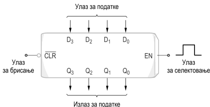
Слика 1.21 Четворобитни регистри за држање података
