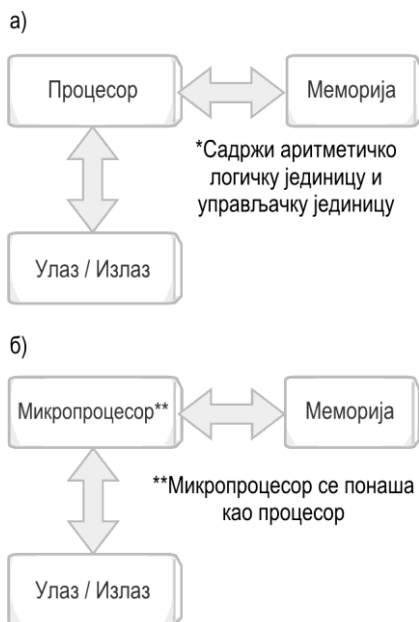
Слика 3.2 а) поједностављени дијаграм рачунара; б) дијаграм микрорачунара
