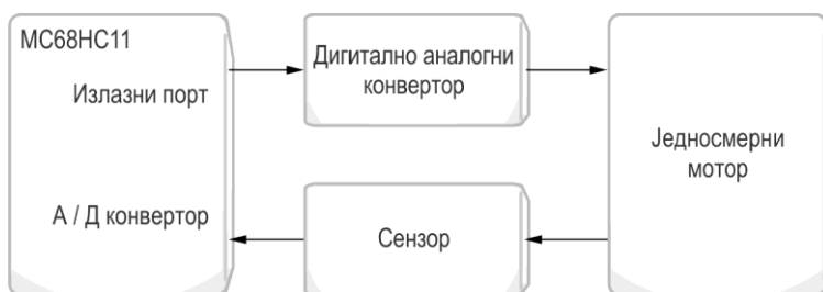
Слика 10.2 Блок дијаграм система за управљање брзином мотора
