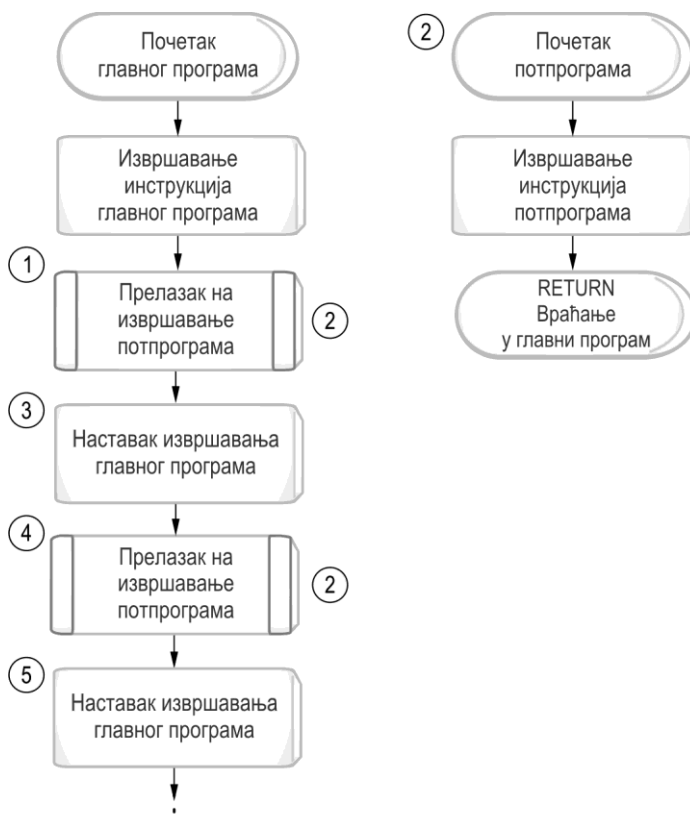
Слика 6.10 Илуструје како скок у потпрограм може да се појави у било којој тачки у главном програму; процесор се на крају потпрограма увек враћа и наставља са извршавањем главног програма
