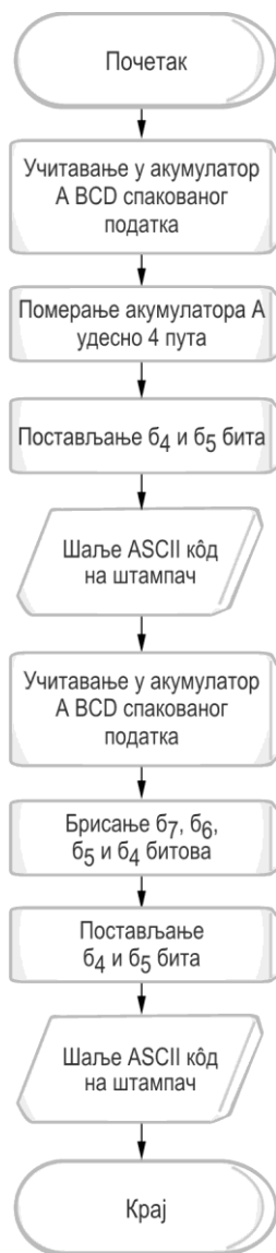
Слика 6.7 Дијаграм тока за конвертовање спакованог BCD податка у ASCII кодирани податак
