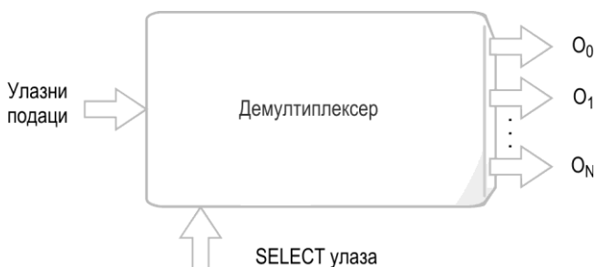
Слика 1.31 Општи модел демултиплексера
