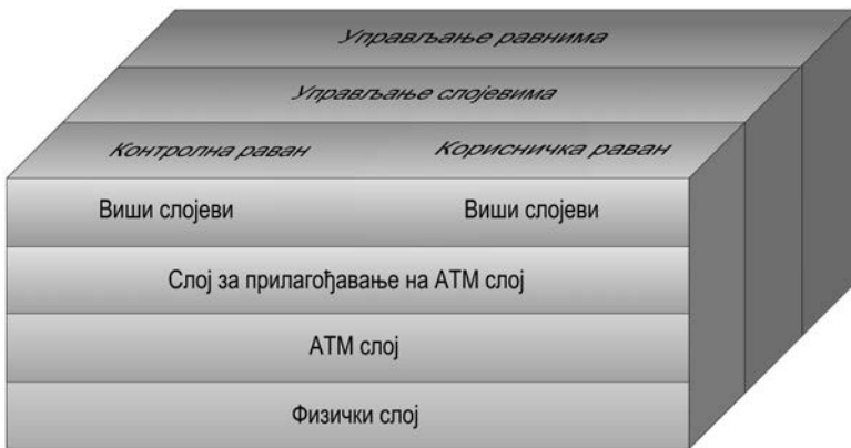
Слика 1.10 ATM референтни модел
