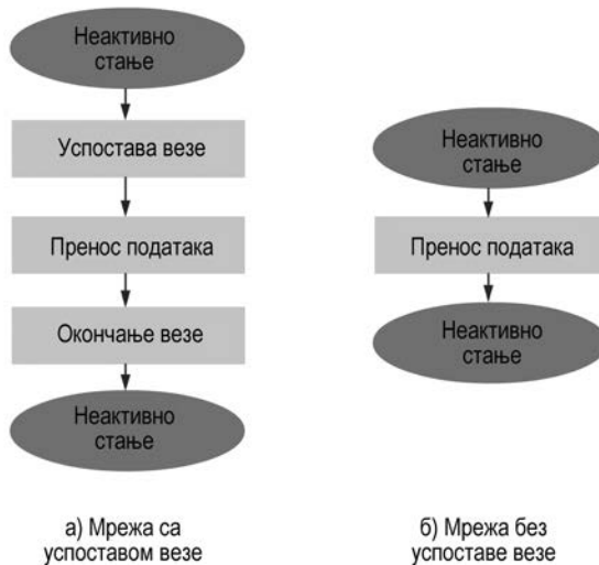
Слика 1.4 Карактеристике услуга са успоставом и без успоставе везе се шаље целокупна информација са адресама пошиљаоца и примаоца назива се датаграм.
