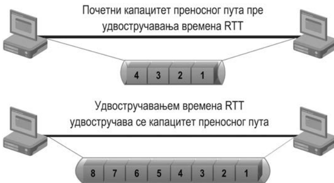
Слика 6.32 Удвостручавањем времена RTT удвостручава се капацитет преносног пута
