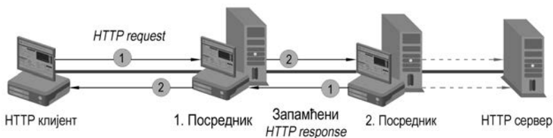
Слика 8.11 Утицај памћења (кеширања) у ланцу HTTP захтева и HTTP одговора
