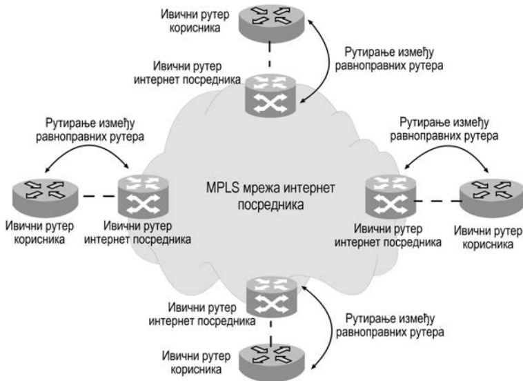
Слика 12.15 Парњак-парњак модел виртуелних приватних мрежа примењен у MPLS виртуелној приватној мрежи
