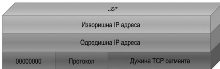
Слика 6.7 Формат псеудозаглавља
