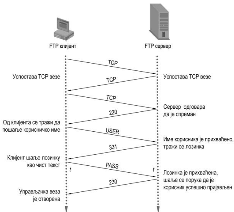
Слика 10.6 Успостављање везе и провера идентитета корисника
