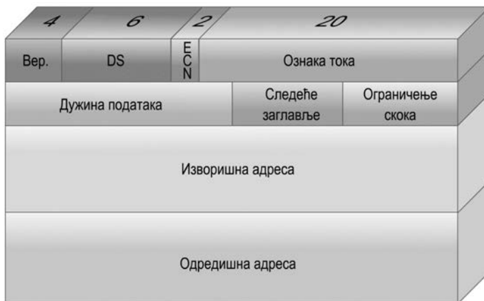
Слика 3.33 Формат заглавља IPv6 пакета
