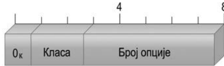
Слика 3.32 Структура поља врста
