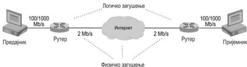
Слика 6.37 TCP проток сегмената и контрола загушења
