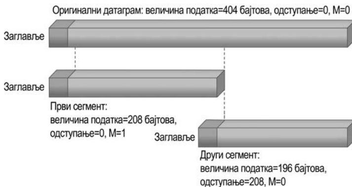
Слика 3.8 Пример деобе пакета (фрагментовања)
