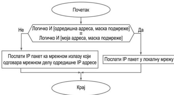
Слика 3.24 Рутирање са подрежавањем
