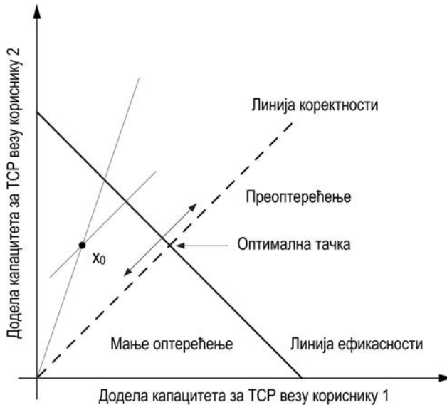
Слика 6.45 Векторско представљање случаја две TCP везе
