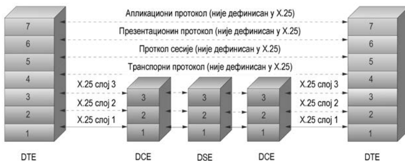
Слика 1.11 Упоређивање X.25 и OSI референтних модела
