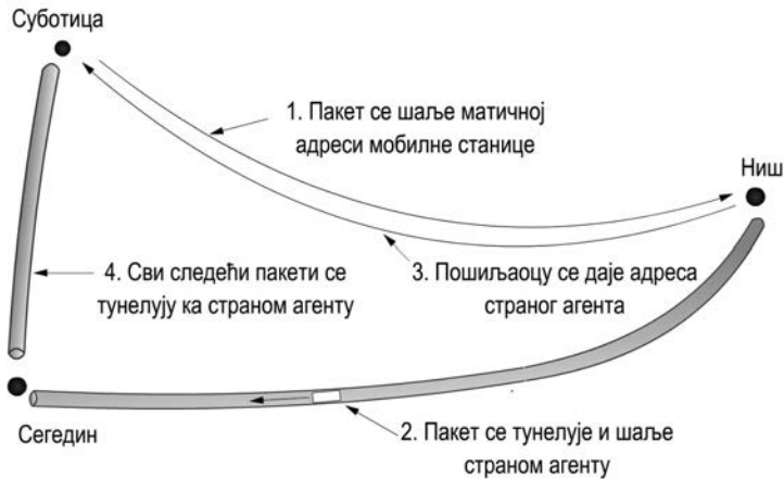
Слика 4.15 Рутирање код мобилних станица
