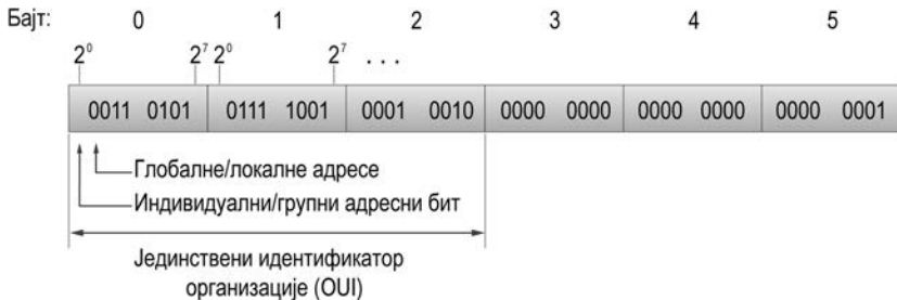
Слика 2.5 Формат адресе MAC-48 и EUI-48 адреса
