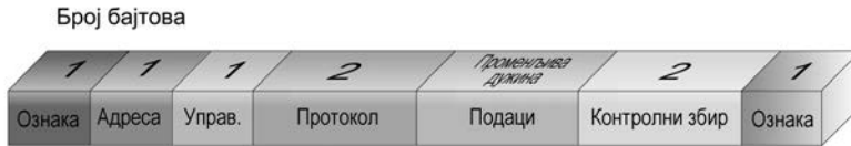
Слика 2.11 Формат рама PPP протокола
