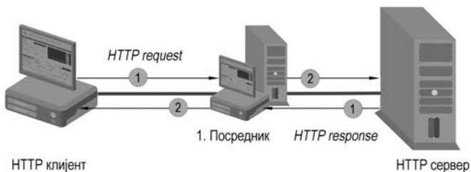
Слика 8.6 Ланац HTTP request/HTTP response : учествује један HTTP клијент, један HTTP посредник и један HTTP сервер
