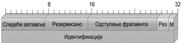
Слика 3.38 Заглавље дела (фрагмента) пакета
