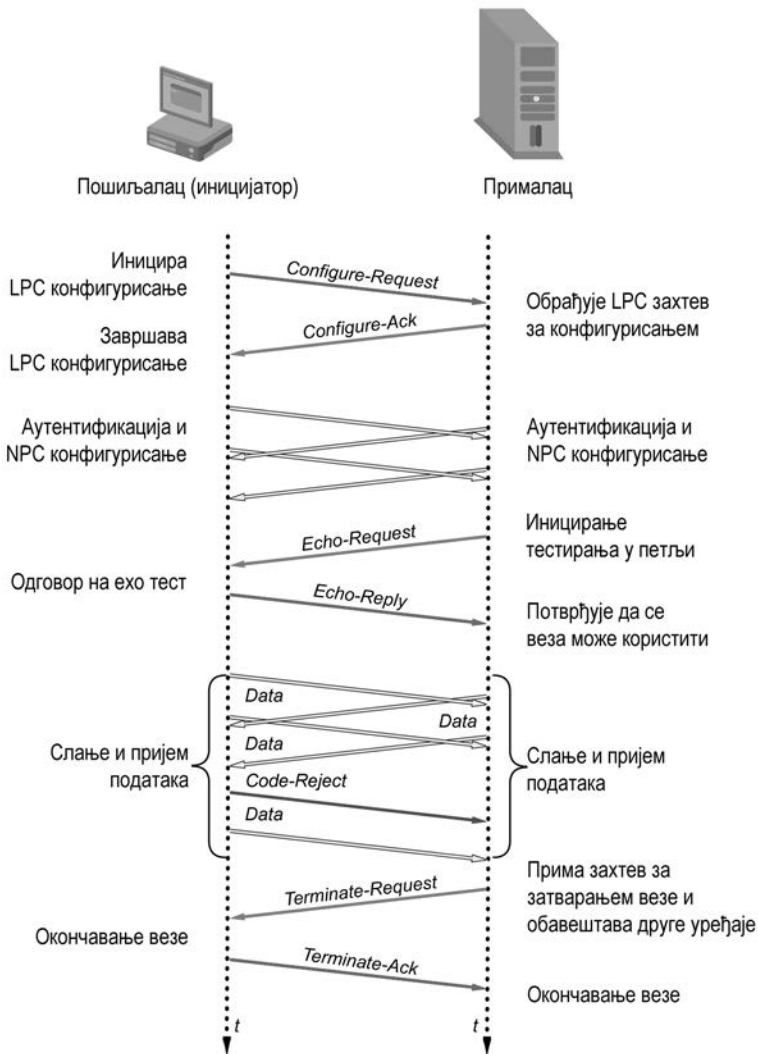
Слика 2.7 Размена LCP порука
