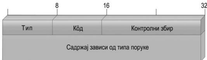
Слика 3.52 Формат ICMPv4 поруке
