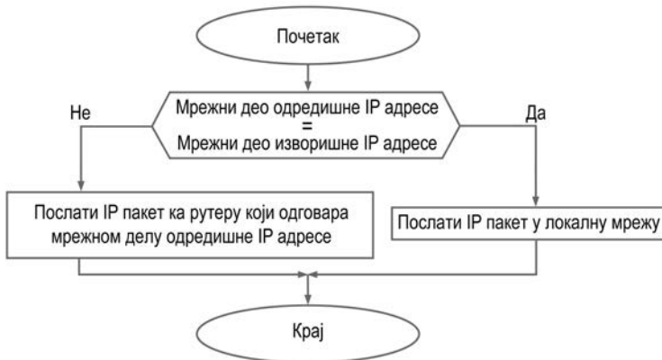
Слика 3.23 Рутирање без подрежа
