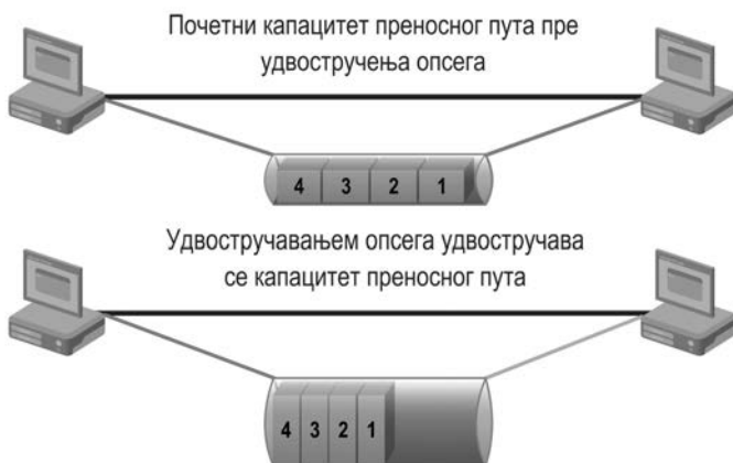
Слика 6.33 Удвостручавањем опсега удвостручава се капацитет преносног пута
