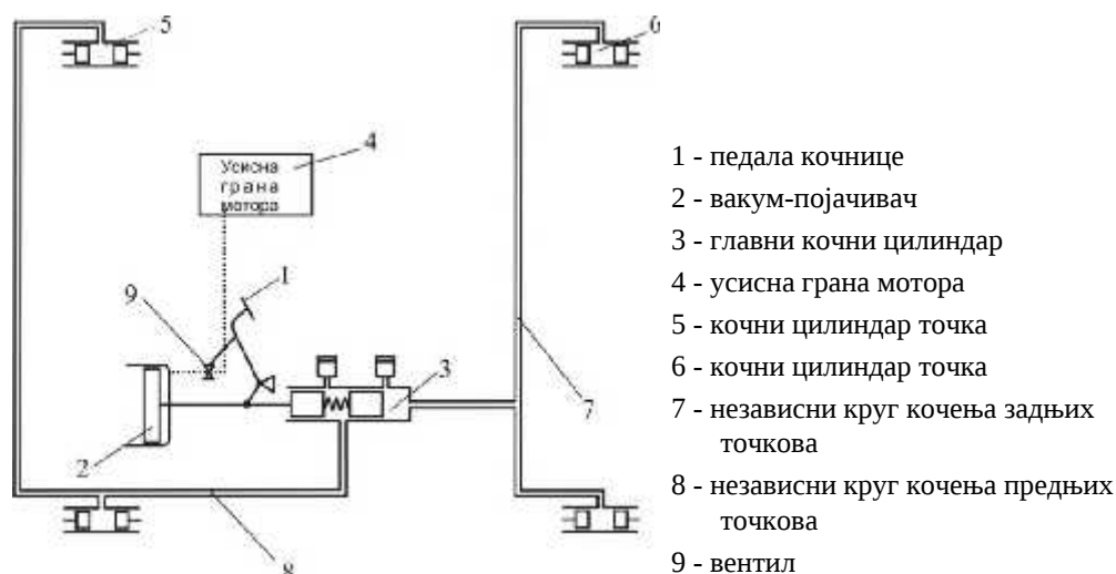
Слика 3.8. Хидраулички преносни механизми са делимичним серво дејством [1]
