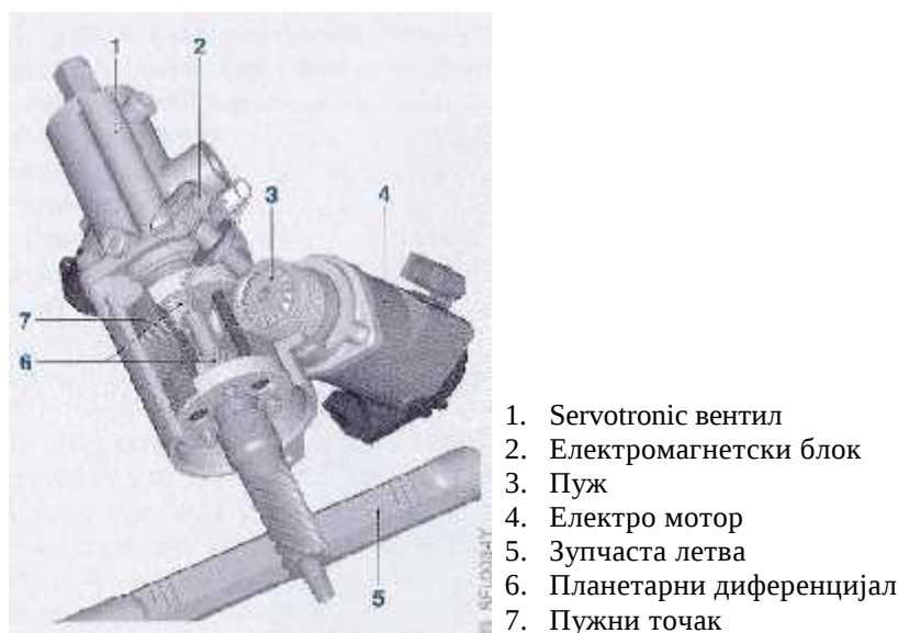
Слика 10.2. Глава управљача кода активног система управљања[1]
