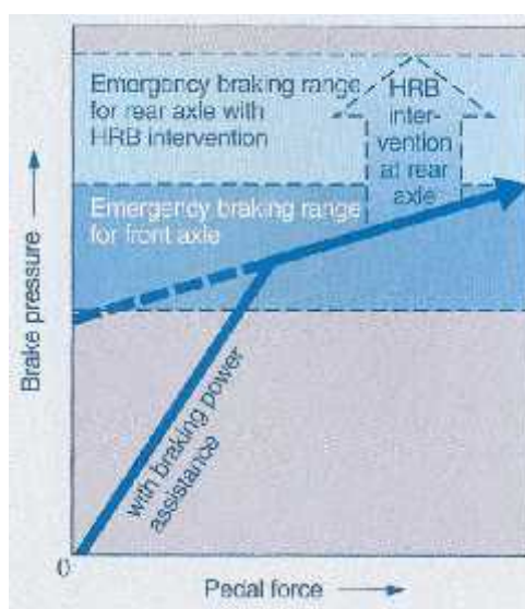
Слика 6.9. Хидраулички појачивач силе кочења на задњим точковима (HRB)[1]
