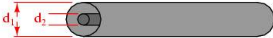
Slika 8. Detalji konstrukcije koaksijalnog kabla
