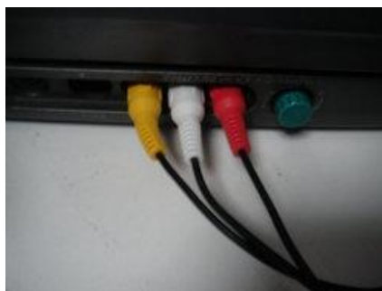
Slika 6. RCA konektori za prenos kompozitnog video signala (žuti), levog (beli) i desnog (crveni) audio kanala
