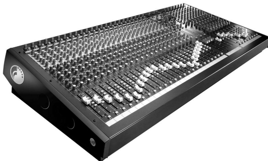
Slika 4 . Izgled miksera sa podeljenim – “split” komandama (Soundcraft)
