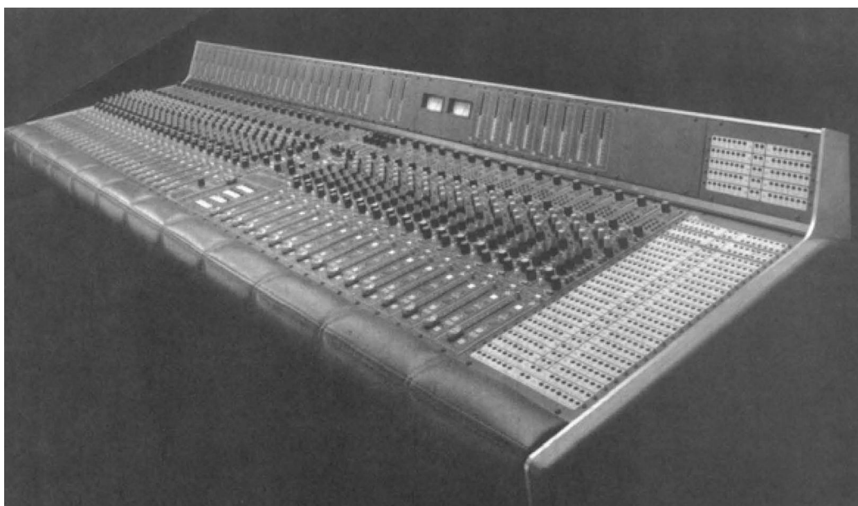
Slika 6 . Izgled miksera sa “in-line” konfiguracijom (Sound Workshop Professional Audio Products Inc.)
