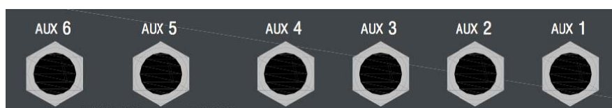
Slika 13. Povezivanje AUX izlaza TRS konektorima
