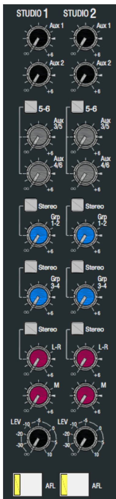
Slika 22. Sekcija Studijskih izlaza na prednjoj strain miksera
