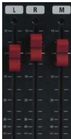
Slika 17. Sekcija Glavnih sabirnica na mikseru
