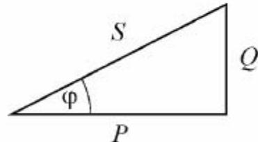
Iz trougla snage mogu se izvesti sledeći izrazi:  $P = S \cdot \cos\varphi$
