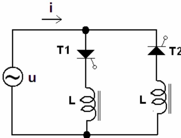
U slučaju ove konfiguracije faznog regulatora ugao paljenja tiristora se može menjati u punom opsegu:
