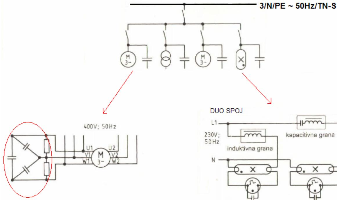
Potrošači reaktivne snage sa paralelno spojenim kondenzatorima
