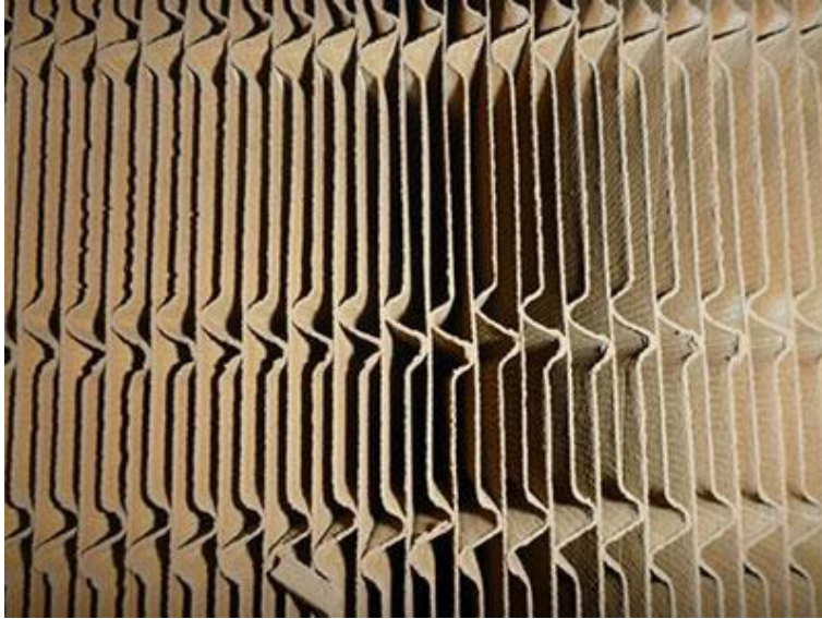
Detaljni prikaz geometrije strukture „saća“
