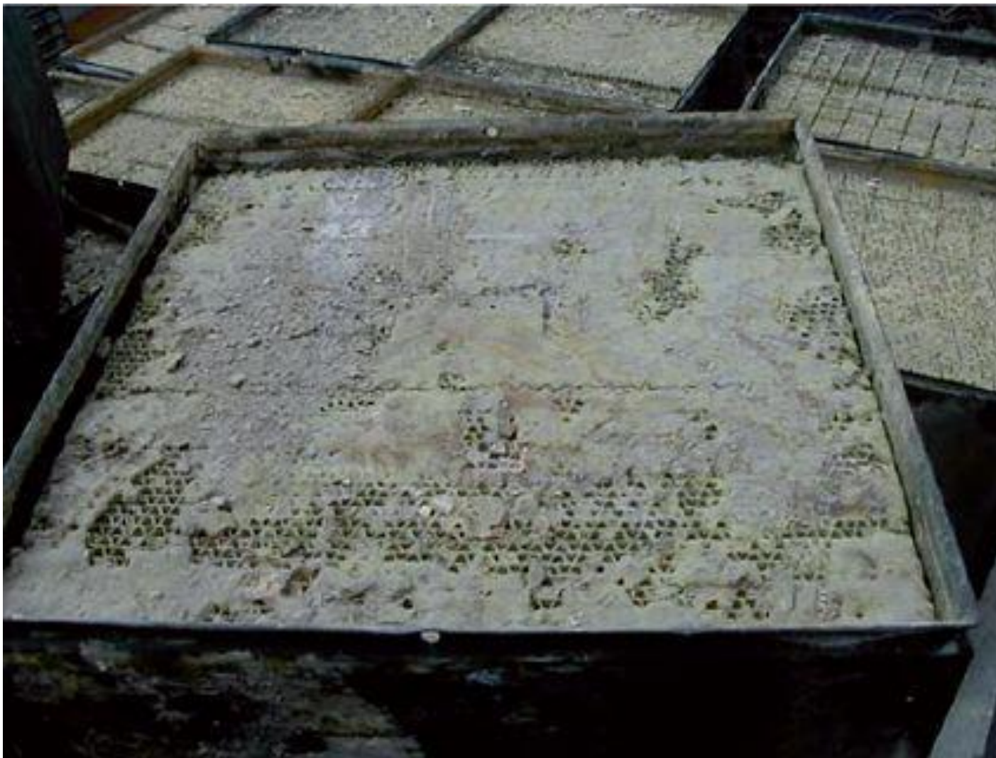
Izgled jednog zasićenog SCR katalizatorskog modula (spreman za čišćenje)
