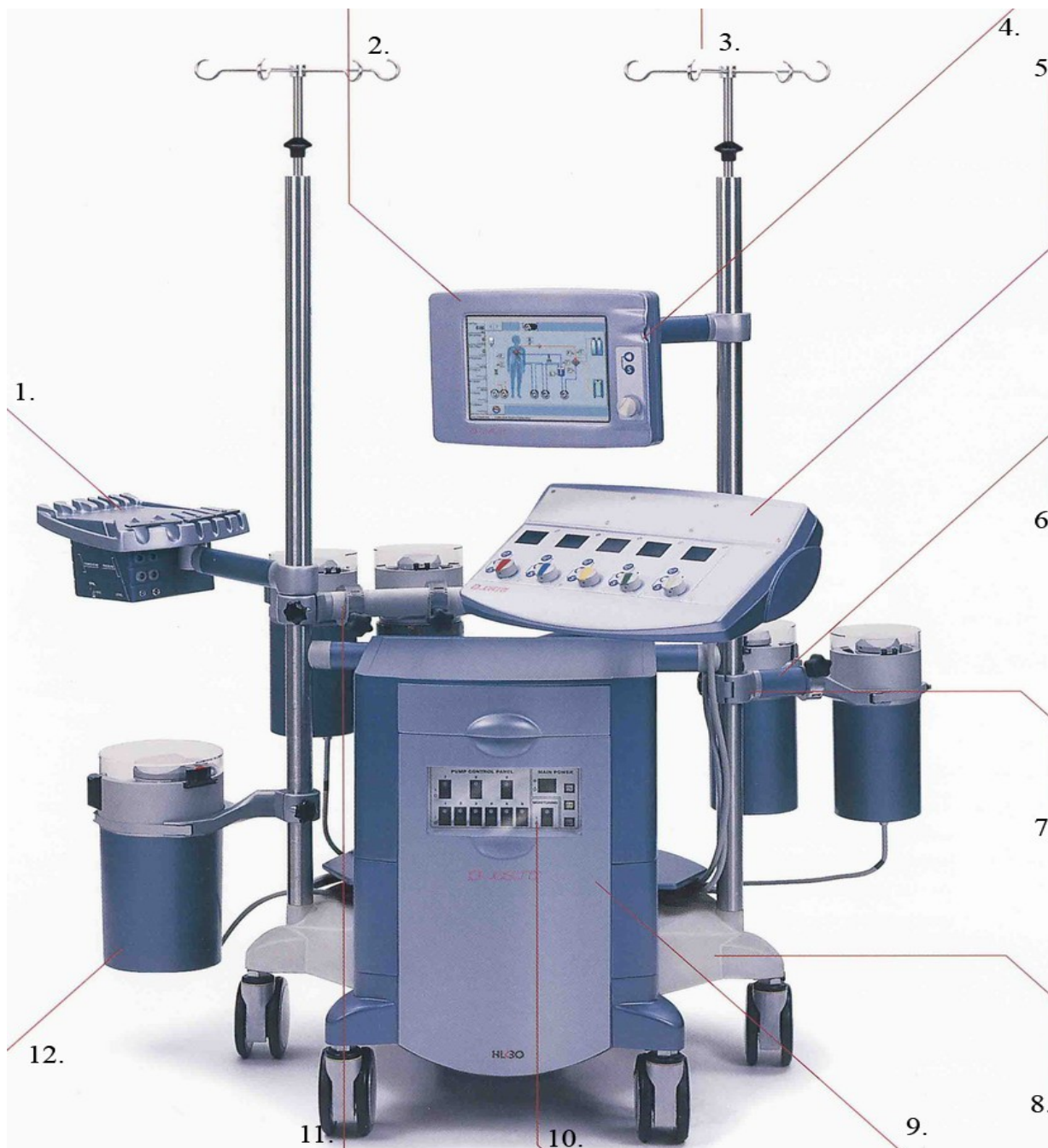
Сл. 11.17. Савремени систем срце – плућа: 1. сензорски мост, 2. управљачка јединица, 3. систем стубова, 4. мултимедијалних систем, 5. комадна табла за пумпе, 6. алуминијумски држачи, 7. држачи стубова и пумпи, 8. клизачи са системом стубова, 9. систем за напајање, 10. табла са прекидачима, 11. носећа шипка, и 12. пумпа за крв.
