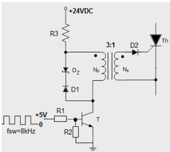
Dimenzionisati pobudno kolo tiristora prikazano na slici ( $R_1$ ,  $R_2$ ,  $R_3$ ,  $V_z$ ) , uz pretpostavku da je u kolu gejta tiristora potrebno ostvariti struju od 1.8A pri naponu gejt-katoda od 4V.
